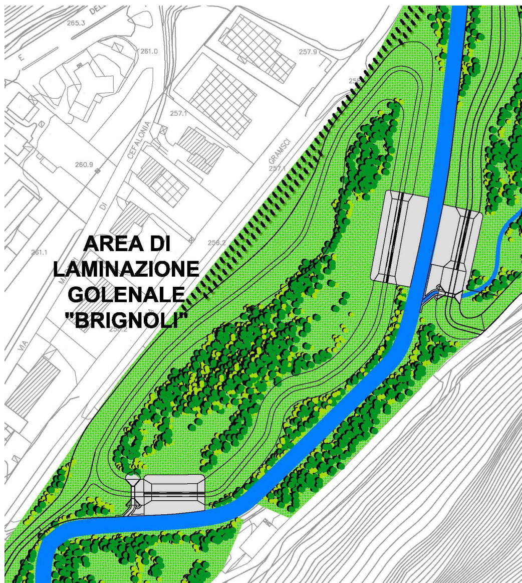
Figura 30 – Planimetria dell'area di laminazione golenale “Brignoli” con progetto del verde
