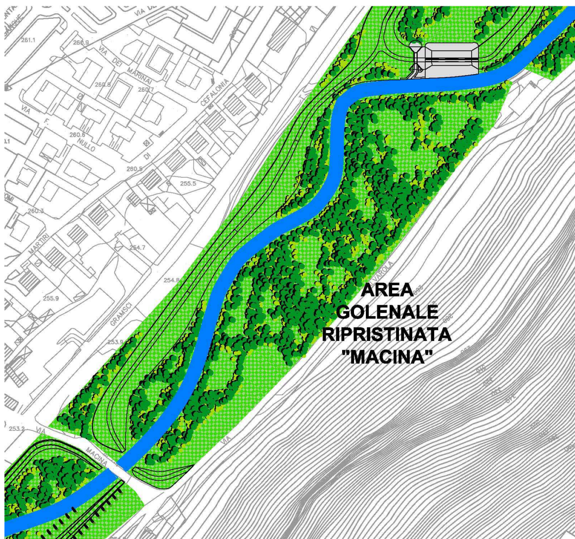
Figura 32 – Planimetria dell'area di espansione golenale "Macina" con progetto del verde
